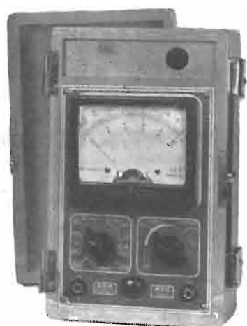
ANALIZZATORE Mod. 601/1 10.000 OHM/VOLT cc. e ca. 5 portate voltmetriche cc. e ca. da 10 e 1.000 Volt - 5 Milliampometriche da 100 microamper a 500 miliamper cc. - Ohmetro in 3 scale da 1 ohm a 5 Megaohm
