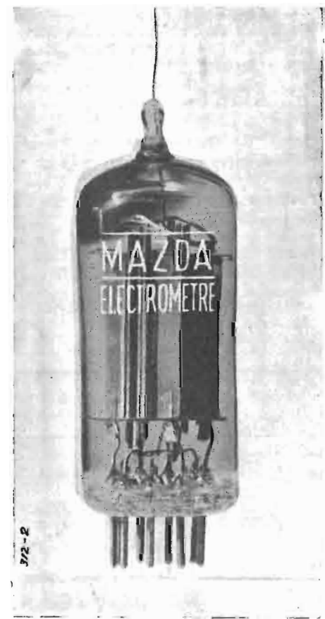
Fig. 1. - Aspetto del tubo elettrometro 6250.
