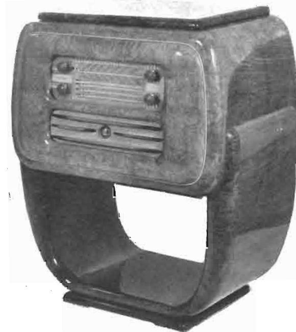
Mod. 560 RGL - Supereterodina a 6 valvole - Cinque gamme d'onda, 2 medie e 3 corte - 2 altoparlanti - Grande scala a specchio - Mobile in radica tipo extra lusso - Occhio elettrico di sintonia - Potenza d'uscita 5,8 Watt con 10% di distorsione - Potenza media 3 Watt con 1,8% di distorsione - Ingombro: 80x75x40 - Complesso fonografico a 3 velocità LESA.
